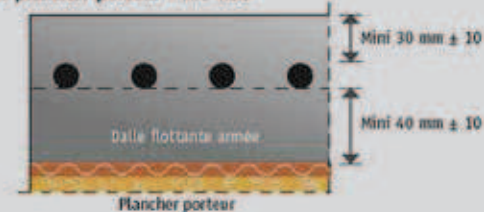
Dalle rapportée flottante armée sur plancher porteur - Art 4.38
