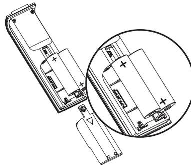
3- Remettez la trappe à piles en place et revissez la vis située à l'arrière de la télécommande.
