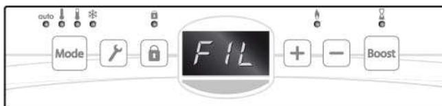
La soufflerie s'arrête. Vérifiez à ce que rien ne soit placé devant la grille de ventilation pour ne pas bloquer le flux d'air. Le filtre peut être obstrué par la poussière, il doit être nettoyé (voir page 18).
