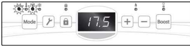
Mode économique, correspond à la température Confort moins 3,5°C. Ceci permet de faire un abaissement sans dérégler la température Confort (exemple si Confort = 21°C alors éco = 17,5°C).
