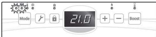
Mode automatique, si votre sèche-serviettes est relié à un gestionnaire d'énergie ou à un programmeur par le biais du fil pilote, il fonctionnera automatiquement en fonction des programmes établis suivant le régime (Confort, éco, Hors-gel) programmé.
