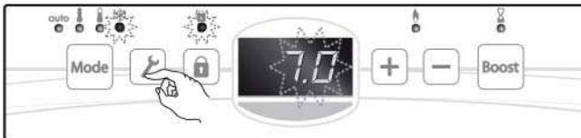
Mode protection Hors-gel, permet de sécuriser les installations d'un logement contre le gel en maintenant une température permanente de 7°C.
