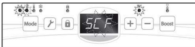
Le voyant du mode sélectionné est allumé, le témoin de chauffe s'allume et le voyant du mode Confort clignote.
