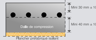
Dalle de compression sur plancher préfabriqué, entrevous isolants
