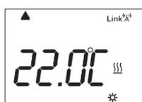
La température de consigne du mode Confort peut être ajustée de 11°C à 30°C par intervalles de 0,5°C.
