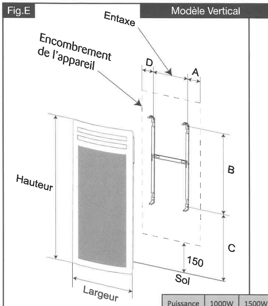
**Conseils :** La sortie du câble d'alimentation à travers le mur doit se faire dans la superficie de l'appareil pour éviter d'être visible après installation. Pour faciliter la mise en place et respecter la cote minimale de 150 mm du bas de l'appareil par rapport au sol (Fig.D).
