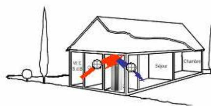
Raccordement gaine en diam 160 mm
